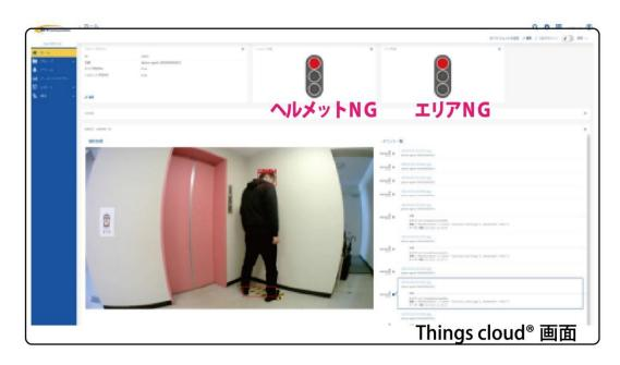
巡回しているロボットのカメラ画像から AI が 作業員の危険を感知 ヘルメット未着用のアラートを出します。
