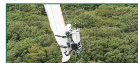
風力発電機ブレード 点検ロボット
